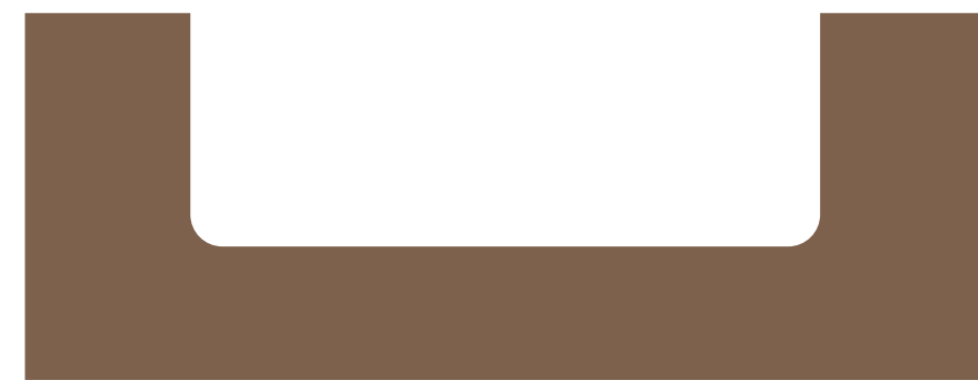
1. 將地基範圍內的土壤挖開。
